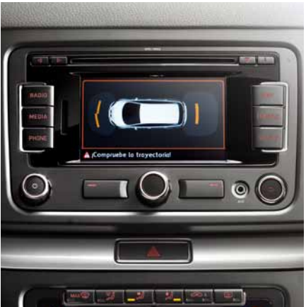
De optische parkeersensoren geven de ruimte rond het voertuig weer op het display van zowel het SEAT Sound System als het SEAT Media System.
