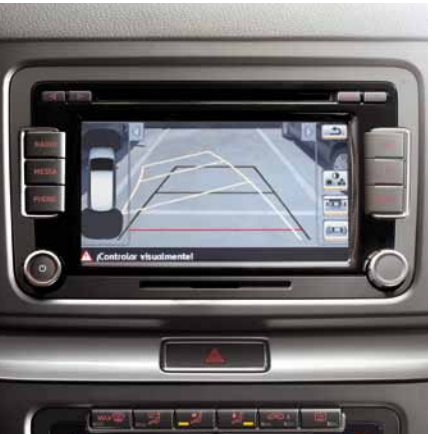
De parkeerassistentie zoekt naar bruikbare parkeer-ruimte en voert de stuuractie automatisch uit.
